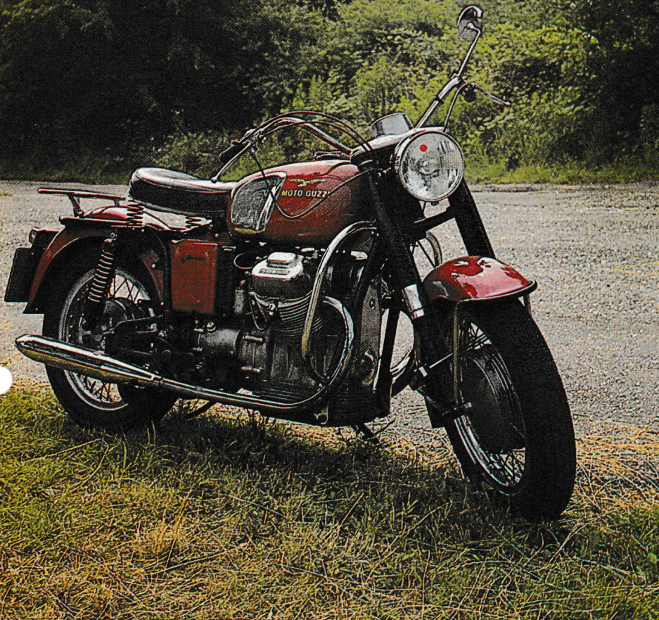
Einen vermeintlich hohen Schwerpunkt der V 7 suggerierten die hoch aufragenden Zylinder. Doch schwere Bauteile wie die Kurbelwelle lagen tief — so bestach der Fünf-Zentner-Brocken durch erstaunliche Handlichkeit.
